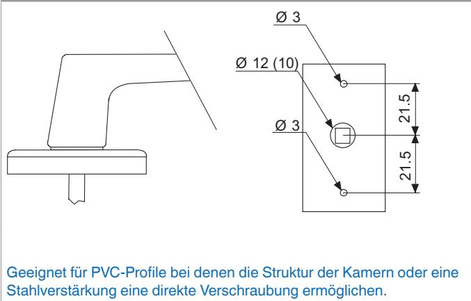
Geeignet für PVC-Profilen bei denen die Struktur der Kamern oder eine Stahlverstärkung eine direkte Verschraubung ermöglichen.
